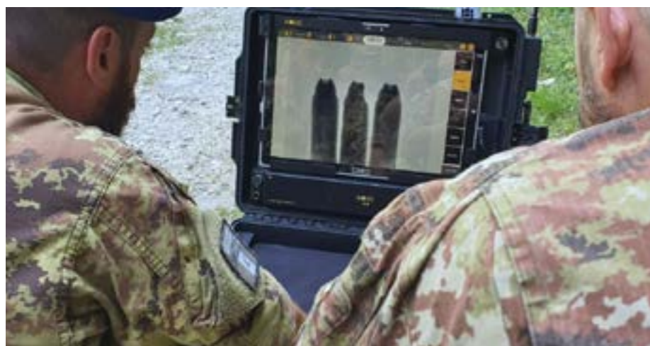
Analisi radiografica su ordigni a presunto caricamento chimico.
